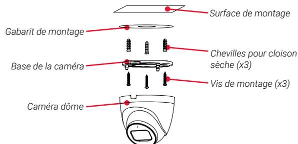
1. Utilisez le guide de montage inclus afin de marquer l'emplacement des trous des vis de montage et des câbles de la caméra.
