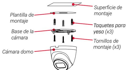
1. Use la plantilla de montaje incluida para marcar los orificios donde colocará los tornillos de montaje y el cable de la cámara.
