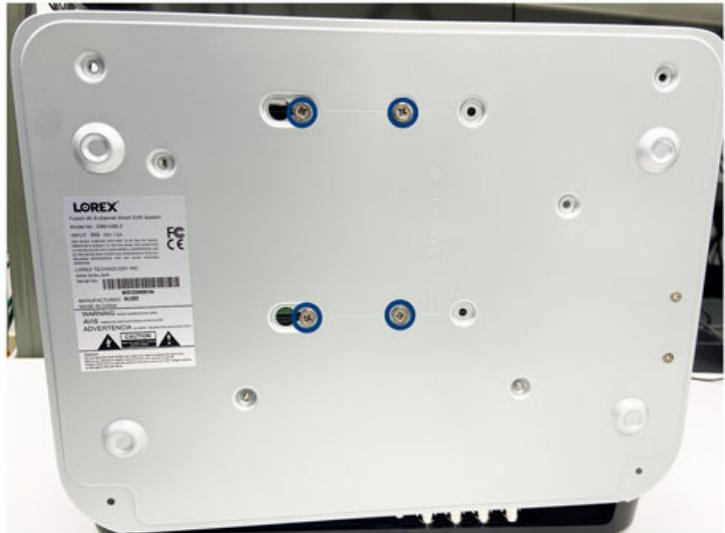
6. Si no va a instalar de inmediato una nueva unidad de disco duro, vuelva a colocar el panel superior y los 6 tornillos del panel inferior.
