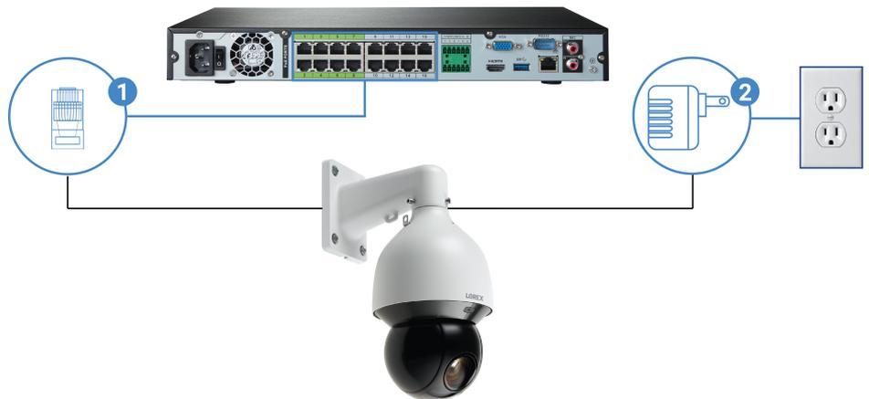
1. Conecte el cable Ethernet a una de las entradas de video de la grabadora.
