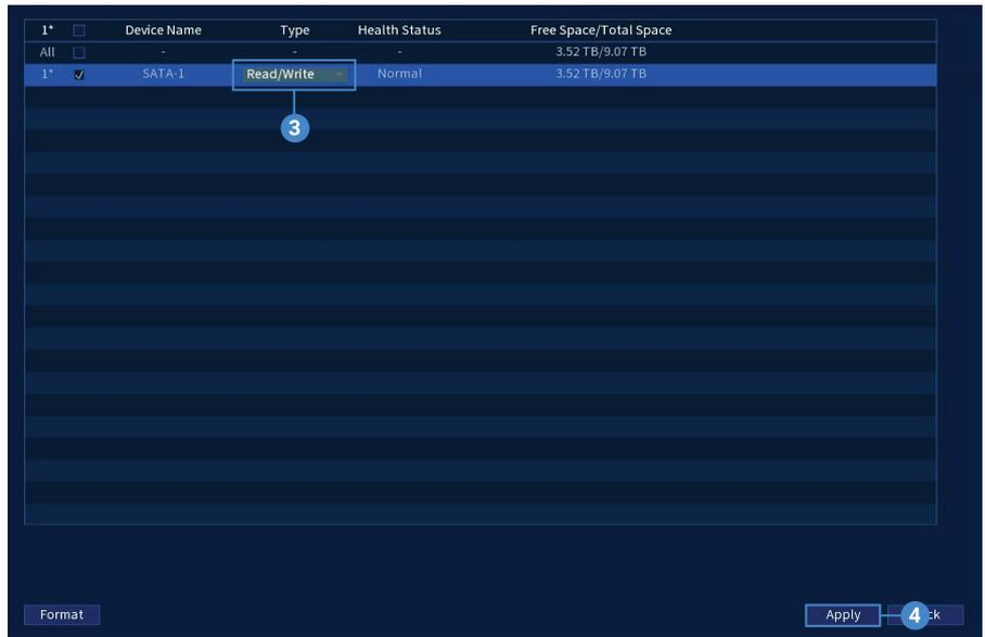
3. Seleccione el tipo de disco duro en la columna **Type** junto al disco duro que desea configurar.
