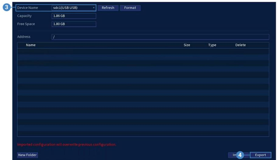
3. En **Device Model**, seleccione el dispositivo USB donde desea guardar la configuración.
